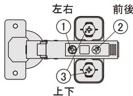
③扉を上下へ動かす時に使います。ネジを左へ回してゆるめてからスライドさせちょうど良いところで右に回して締め付けます。
