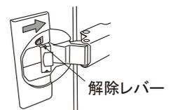
解除レバーを矢印の方向にスライドさせ扉を閉めると解除します。戻す場合はレバーを反対方向にスライドさせて下さい。
