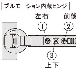
②扉を前後へ動かす時に使います。ネジを左右どちらかに回してスライドさせちょうど良いところで止めます。(カム式構造)
