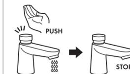
ヘッド部分を押しすることで吐水し設定した時間が経つと止水します。手の甲や肘でも押して吐水ができるので衛生的です。吐水時間を約 7 秒、15 秒、30 秒のいずれかにあらかじめ設定できます。
